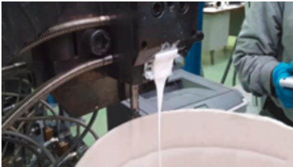
Abb. 4 // Konzeptnachweis für die Emulgierung von Kurzöl-Alkyd durch Schraubenextrusion.
